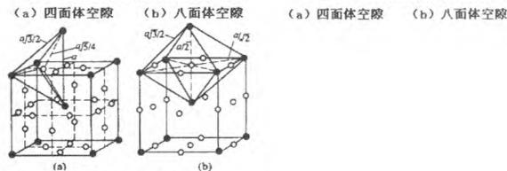
图3 体心立方结构的空隙
