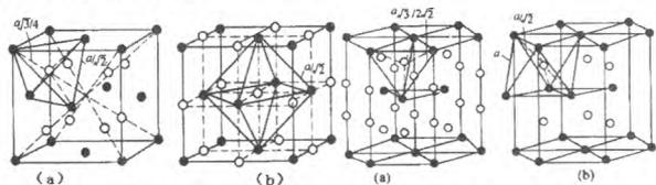
图1 面心立方最密堆积结构的空隙
