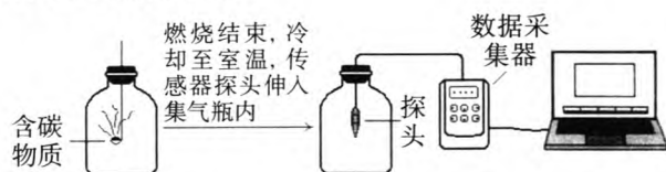
图1 传感器测量含碳物质在密闭集气瓶里燃烧
