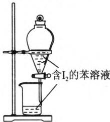
C 苯萃取碘水中  $\text{I}_2$ , 分出水层后的操作
