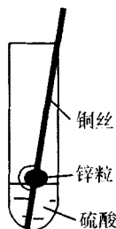
图1 原电池演示实验改进装置
