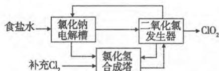
②该法工艺原理如上。其过程是将食盐水在特定条件下电解得到的氯酸钠(NaClO<sub>3</sub>)与盐酸反应生成ClO<sub>2</sub>。
